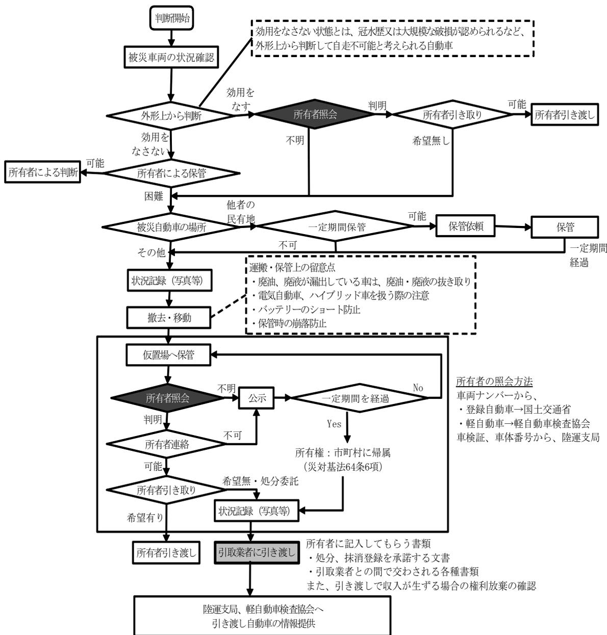
図 5.12.1 自動車の処理フロー例
