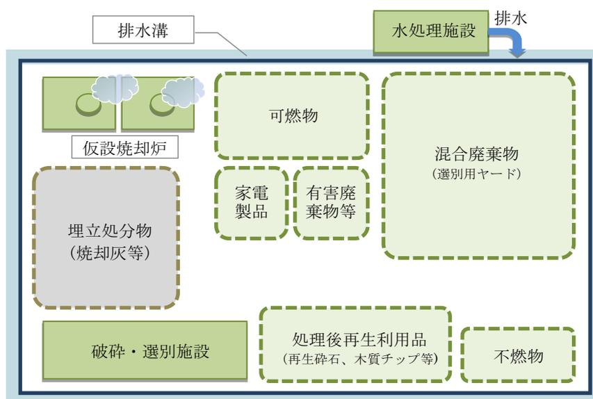
図 5.7.1 二次仮置場における中間処理施設の施設配置案
