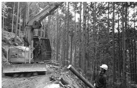
作業道を開設し、最新の林業専用重機で、木材を集めて搬出する方法(路網システム)
