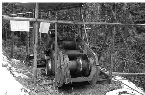
集材機を操作してワイヤーロープで木材を運ぶ方法(架線システム)
