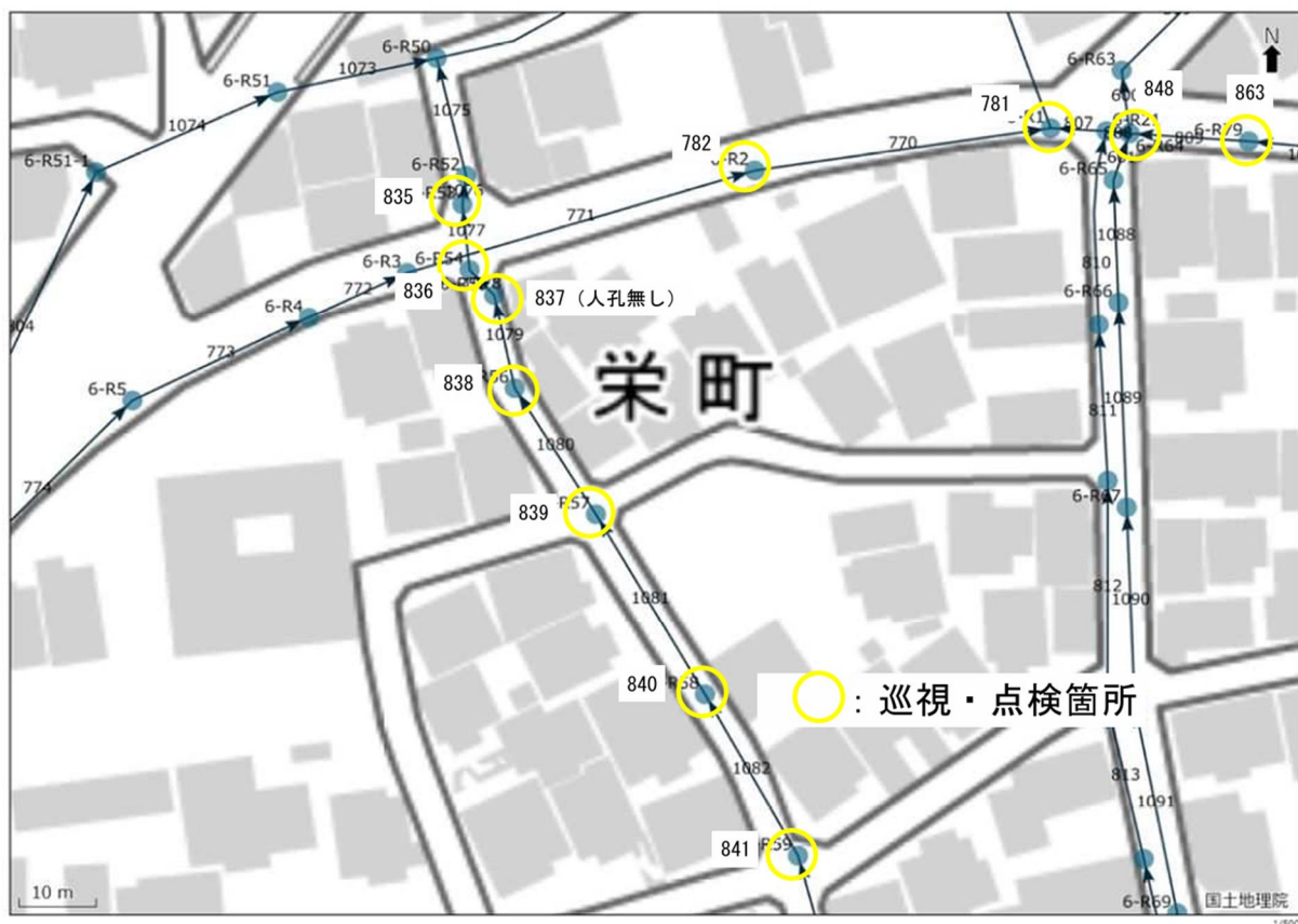
図 5-12 雨水管路 巡視・点検位置図（詳細図）
